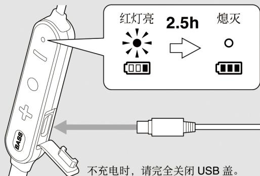
· 请务必使用输出电压为 5V 的 USB 电源适配器, 否则会导致故障及异常发热。
