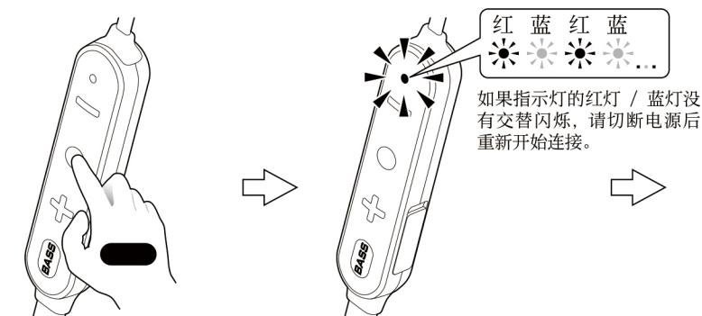
从切断电源的状态开始, 请长按按键, 直至指示灯红灯 / 蓝灯快速地交替闪烁。
