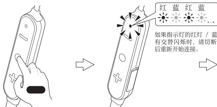
从切断电源的状态开始，请长按按键，直至指示灯红灯 / 蓝灯快速地交替闪烁。
