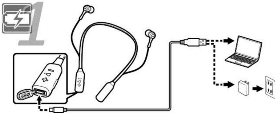
●请务必使用输出电压为5V的USB电源适配器，否则会导致故障及异常发热。
